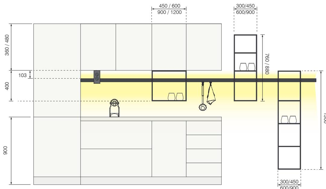
ESEMPIO DI INSTALLAZIONE IN CUCINA (dimensioni in mm)
