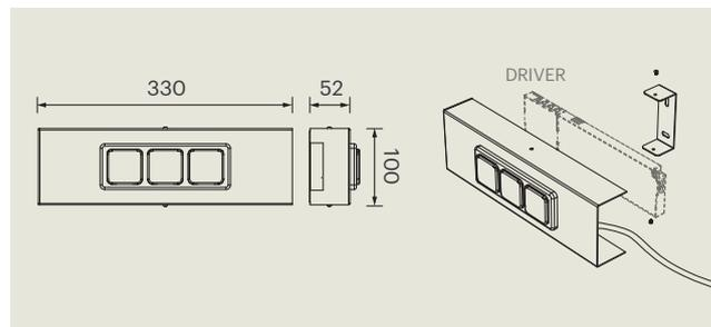
3x SCHUKO - PRESA ORIZZONTALE TRIPLA (ALLOGGIAMENTO MEC DRIVER)
